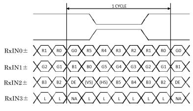
DE : DATA ENABLE HS : H<sub>SYNC</sub> VS : V<sub>SYNC</sub>
