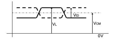
5) V<sub>CM</sub>: LVDS Common mode voltage (V<sub>CM</sub>=1.25V)
