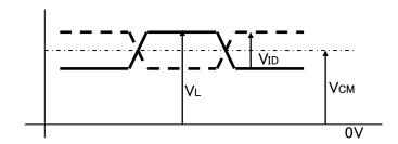
5) V<sub>CM</sub>: LVDS Common mode voltage (V<sub>CM</sub>=1.25V)
