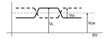
5) V<sub>CM</sub>: LVDS Common mode voltage (V<sub>CM</sub>=1.25V)
