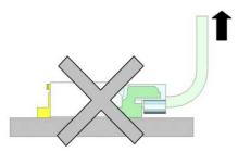
カバーをロックした状態で、FPC/FFC に引張力を加えないで下さい。FPC/FFC 導体面の削れ、及び半挿入状態による導通不良の原因となります。
